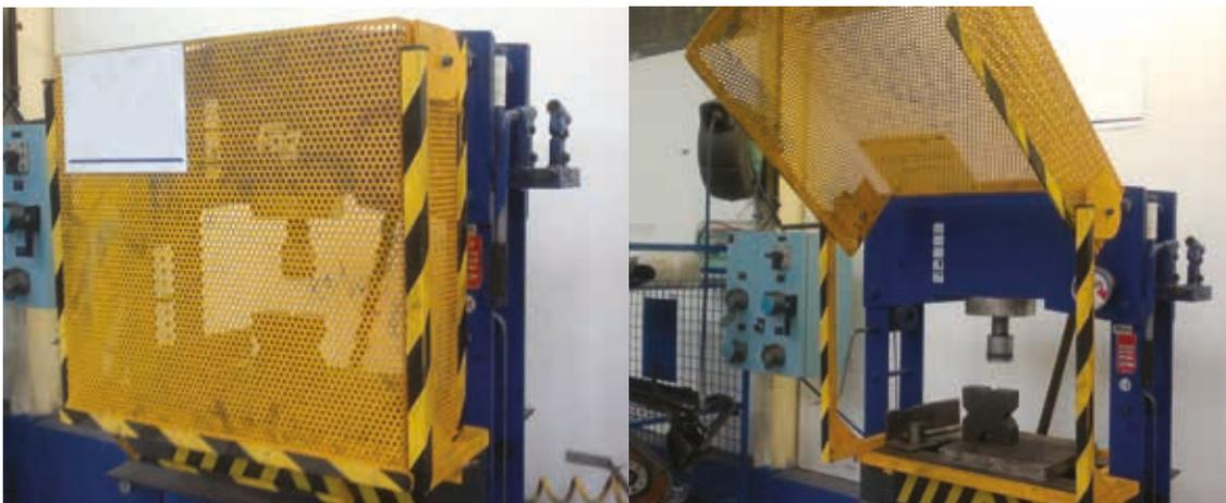
Presse hydraulique pour redresser, emmancher, remonter les roulements, etc.
