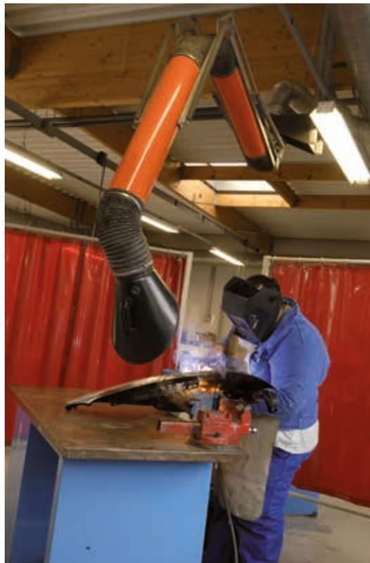
Poste de soudage équipé d'une buse mobile d'aspiration des fumées
