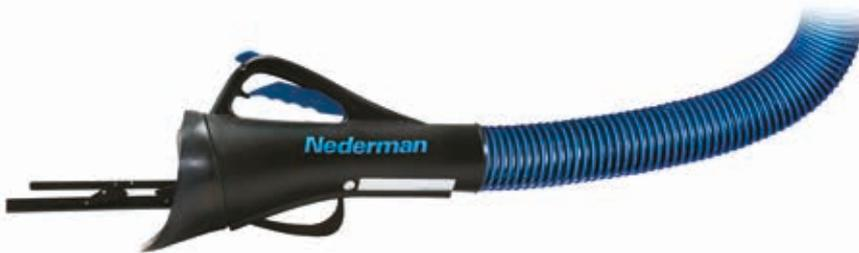
Embout universel de captage des gaz d'échappement. Les 2 tiges horizontales s'écartent pour serrer à l'intérieur du tuyau d'échappement.
