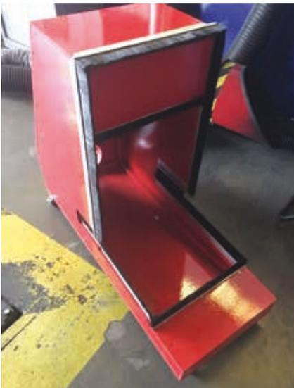
Capteur mobile dit « GAZEL » permettant une optimisation du captage sans réglage complémentaire et idéal pour un usage en zone de réparation rapide.
